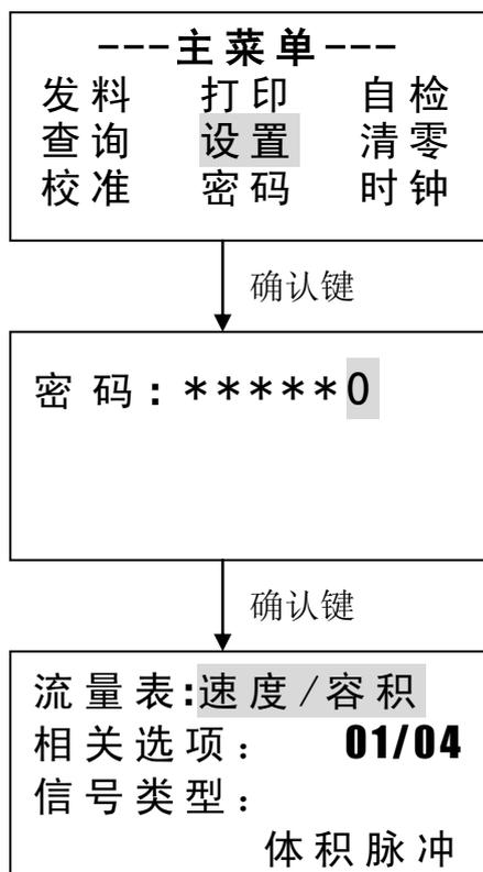
流量表：速度/容积；质量流量；差压流量；孔板差压；V锥差压。
